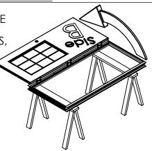
REMOVE THE HINGE SCREWS FROM THE DOOR PANEL
